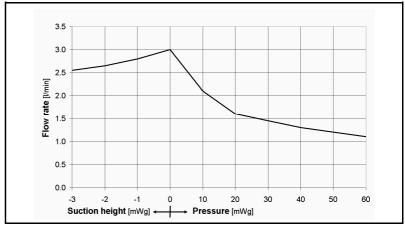
Fig. 4: Flow rate curve for Liquiport<sup>®</sup> 1.300
