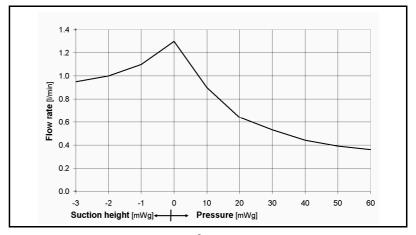
Fig. 2: Flow rate curve for Liquiport<sup>®</sup> 1.100
