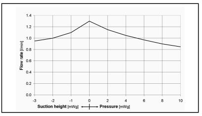
Fig. 1: Flow rate curve for Liquiport<sup>®</sup> 100
