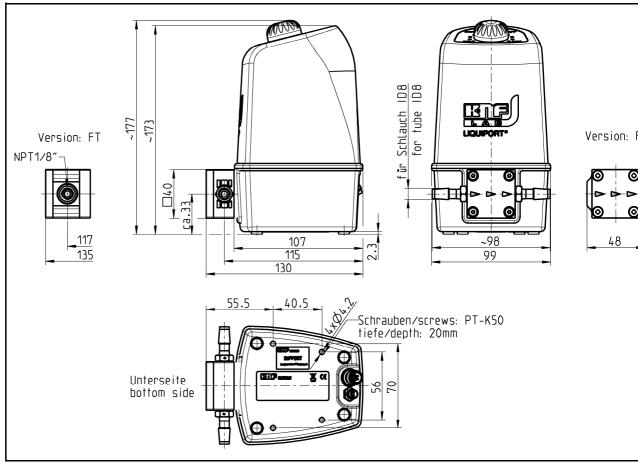
Fig. 8: Mounting dimensions for Liquiport<sup>®</sup> 100 / Liquiport<sup>®</sup> 1.100 (dimension tolerances as per DIN ISO 2768-1, tolerance class V)
