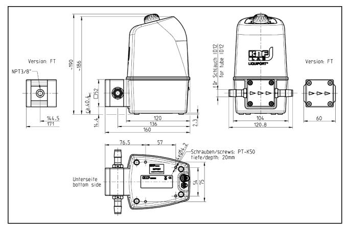
Fig. 9: Mounting dimensions for Liquiport<sup>®</sup> 300 / Liquiport<sup>®</sup> 1.300 (dimension tolerances as per DIN ISO 2768-1, tolerance class V)
