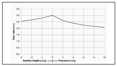
Fig. 3: Flow rate curve for Liquiport<sup>®</sup> 300
